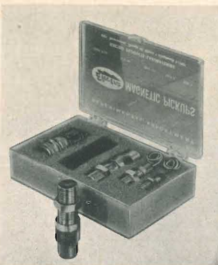
La ELECTRO PRODUCTS LAB. annuncia una serie di rivelatori magnetici i quali generano ai morsetti di uscita una tensione la cui frequenza è funzione della velocità con la quale dei corpi metallici magnetici esterni interrompono o alterano il campo magnetico generato dai rivelatori stessi. Tali trasduttori possono trovare impiego in svariatissimi campi di misura per rivelare: velocità, posizioni angolari, variazioni di velocità, vibrazioni, coppie, ecc. Ulteriori informazioni presso l'agenzia italiana della SYLVAN GINSBURY LTD, Milano.
