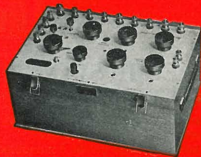
Fig. 7 - Ponte per misure di resistenza
