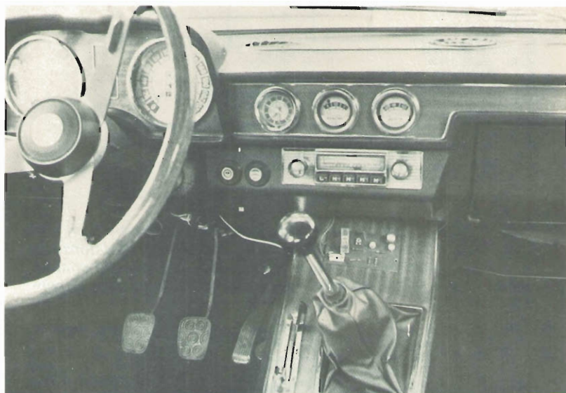
Montaggio su autovettura. Notare come la fotocellula non riceva l'illuminazione direttamente dall'esterno dell'abitacolo.
