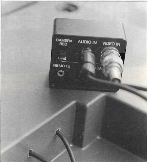
Foto 6 - I cavetti, muniti di appositi Jack RCA e BNC, fuoriescono dal retro dell'apparecchio, pronti all'uso.
