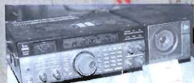
IC 737 Ricetrasmittitore HF multibanda con accordatore autonomo d'antenna - 500 KHz/30 MHz - 10/100 W SSB - CW, FM, 4/40 W AM 100 memorie
