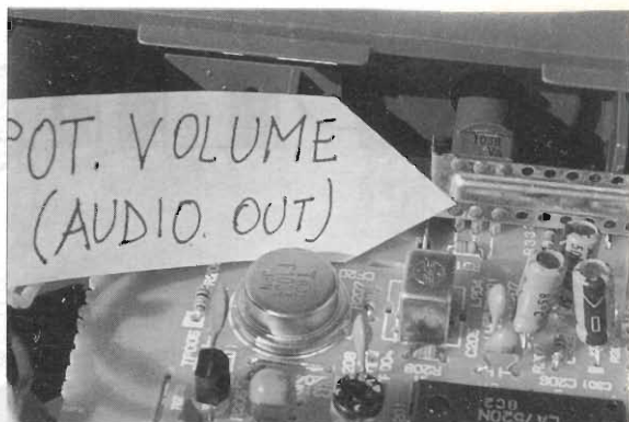
Foto 5 - L'uscita audio può essere presa dal potenziometro del volume direttamente dall'altoparlante (se il livello è troppo basso).
