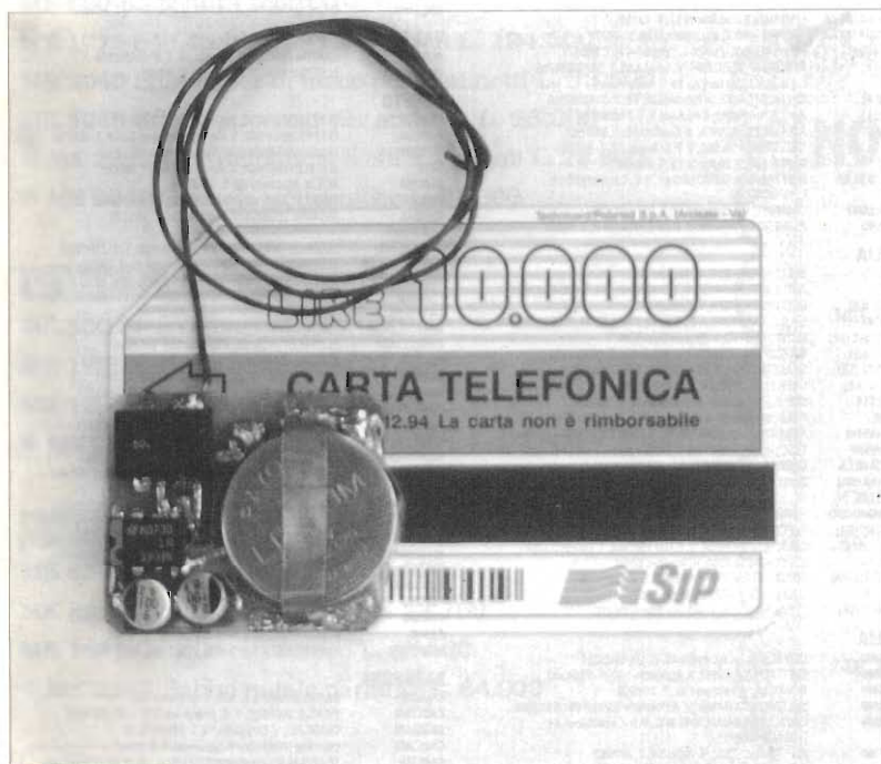
Foto 1 - Un radiolocalizzatore di piccole dimensioni operante in VHF, 1 Km massimo di portata, autonomia circa 3 giorni. Il circuito differisce da quello descritto solo per l'impiego di un modulo trasmittente realizzato in "chip". Questo componente non è in commercio, è stato realizzato per l'autore, per impieghi speciali.
