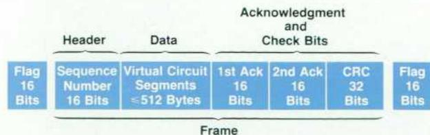
Fig. 8. Trunk link frame format.
